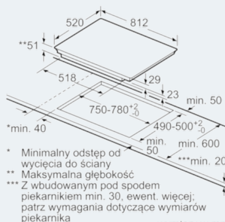
① Należy uwzględnić miejsce na szczelinę wentylacyjną wymiary w mm
